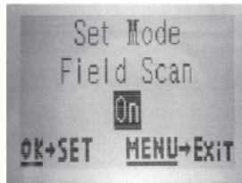
[Paso 1]: poner el modo de exploración de campo en "Encendido".
